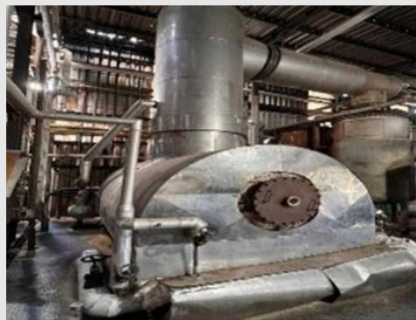
DAG02- DESTILADOR DE ÁCIDOS GRAXOS COMPLETO MATERIAL - AÇO INOX CAPACIDADE - 1000 KG/HORA | Item: 93 |
