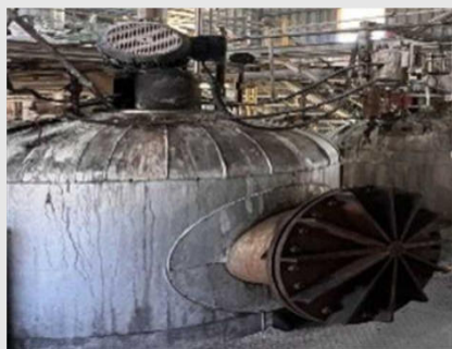
RHD02 - REATOR DE HIDROGENAÇÃO MATERIAL - AÇO INOX CAPACIDADE DE 03 TONELADAS | Item: 102 |
