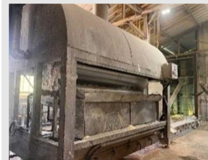
RE01 - ROLO ESCAMADOR MATERIAL - AÇO INOX CAPACIDADE 1000 KG/HORA | Item: 104 |
