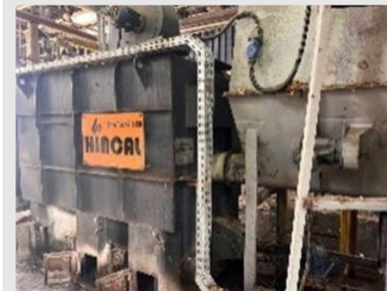
QBM01 - QUEIMADOR DE BIOMASSA VAP. 02 MODELO - HQPS POTENCIA - 800.000 KCAL/H | Item: 59 |
