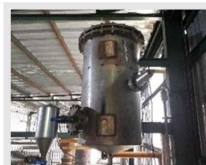
DESAG01 ? DESAERADOR DE ÁCIDO GRAXO MATERIAL INOX CAPACIDADE: 0,29 M³/H MARCA USDA | Item: 15 |
