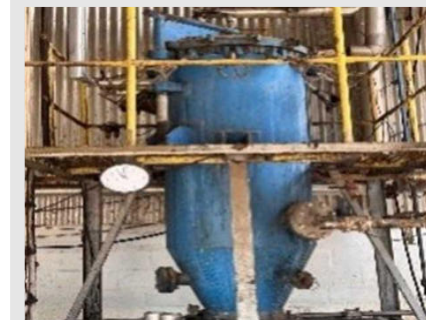
FP01 - FILTRO PLACA HERMÉTICO MODELO - 1001661 CAPACIDADE - 3 TONS/H | Item: 6 |
