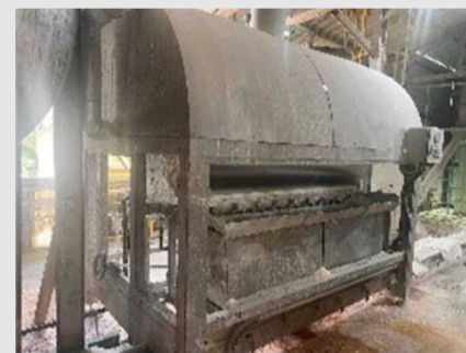
RE02 - ROLO ESCAMADOR MATERIAL - AÇO INOX CAPACIDADE 600 KG/HORA | Item: 88 |
