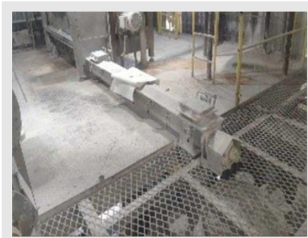
RT02 - ROSCA TRANSPORTADORA MATERIAL - AÇO INOX CAPACIDADE - 1000 KG/H | Item: 90 |
