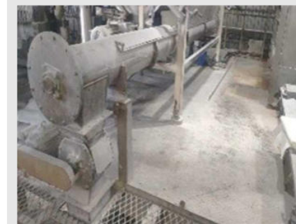
RT01 - ROSCA TRANSPORTADORA MATERIAL - AÇO INOX CAPACIDADE - 1000 KG/H | Item: 89 |
