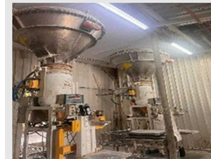
ENS01 /ENS02 - ENSACADEIRAS AUTOMÁTICA MODELO - ES 5000 CAPACIDADE - 350KG/MIN | Item: 30 |
