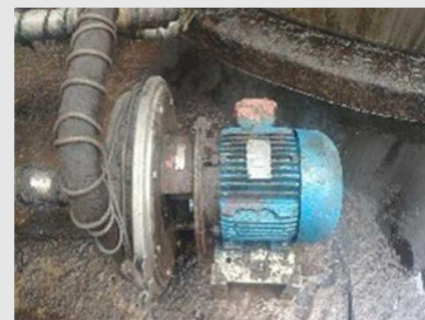
MBTP03- BOMBA DE TRANSFERENCIA DE PRODUTO MATERIAL - AÇO INOX POTENCIA - 5 CV | Item: 82 |
