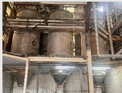
SE01 /SE02/SE03 - SILOS DE ESTOCAGEM MATERIAL - AÇO INOX CAPACIDADE - 10 TON | Item: 29 |
