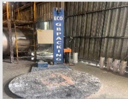
EA01 - ESTRECHADEIRA AUTOMÁTICA MODELO - ECO CAPACIDADE - 60 PALETES/H | Item: 32 |
