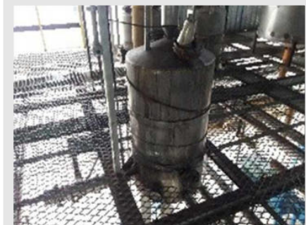
TPAGD01 ? TANQUE PULMÃO DE ÁCIDO GRAXO DESTILADO MATERIAL INOX CAPACIDADE: 0,33 M³/H MARCA USDA | Item: 16 |
