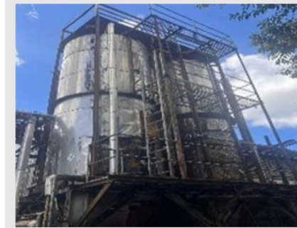
CAG01/CAG02 - CRISTALIZADORES DE ACIDOS GRAXOS MATERIAL - AÇO INOX CAPACIDADE - 25 M³ | Item: 39 |
